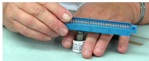
Рис. 2. Ручной процесс контроля силы расчленения контакта
